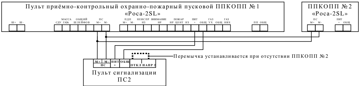
Рисунок 9. Подключение ППКОПП «Роса-2SL» к пульту сигнализации ПС2.
